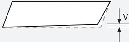
Winkelablenkung V zwischen dem einen Ende der Lamelle und dem anderen Ende
