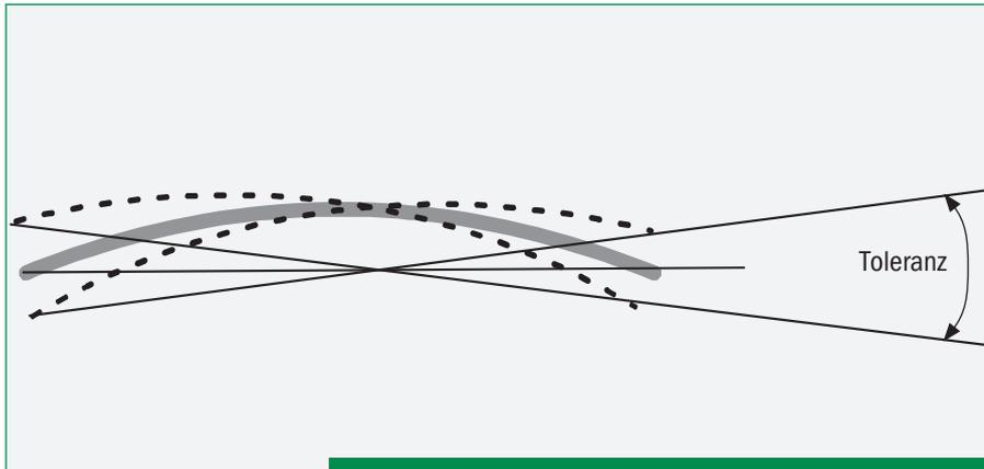
Nach maximaler Öffnung des Lamellensystems dürfen die Lamellen im mittleren Höhendrittel einer senkrechten Scheibe von der waagrechten nach der folgenden Tabelle abweichen:
