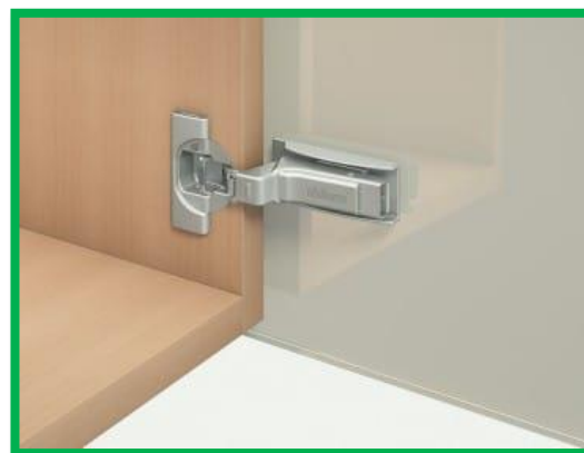
Cristallo-Scharnier für rundum überstehende Fronten (Topfbohrung am Korpus)
